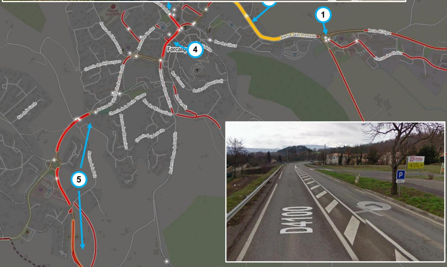
**D4100 Sud-Est** : liaison importante avec Mane non aménagée. Vaste giratoire. Pont sur le Viou : largeur trottoir côté Nord 0,80 m, côté Sud 2,40 m
