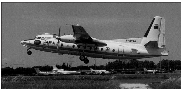
L'ARAT (Avion de Recherches Atmosphériques) prend son envol en direction de la vallée de la Durance où il va effectuer des mesures. Cet avion possède une instrumentation très complète, particulièrement en ce qui concerne les constituants chimiques gazeux, dont l'ozone et les oxydes d'azote. Cet appareil a fourni pendant douze ans une importante quantité de mesures scientifiques. Il effectue ses derniers vols dans le cadre d'ESCOMPTE.
