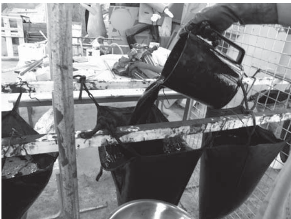
Extraction de l'indigo (macération, oxygénation/décantation, filtration, conditionnement).
