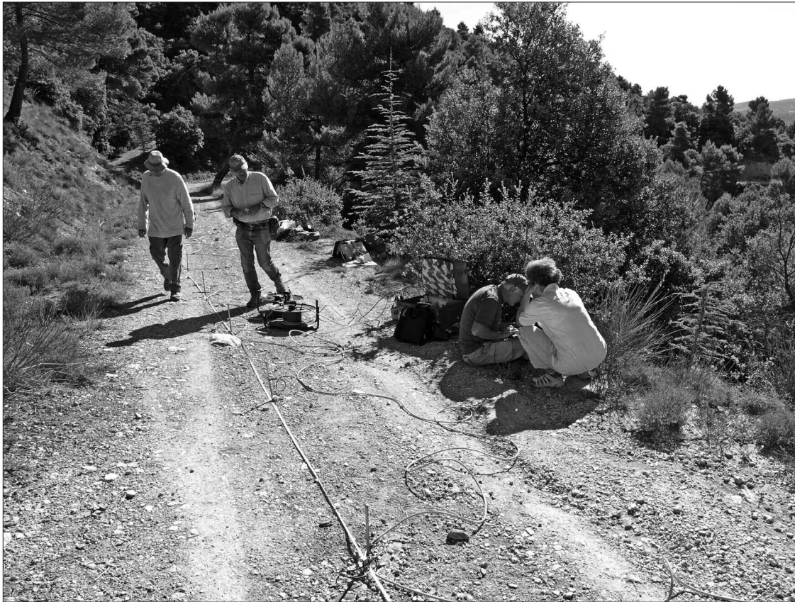
Sur le terrain, pour la tomographie électrique.
