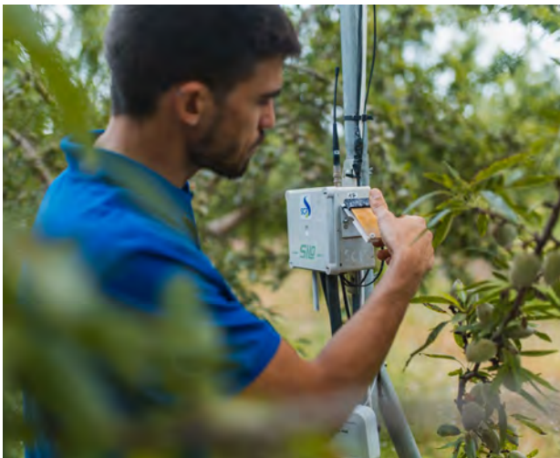
Station communicante d'acquisition et transmission de la donnée, parcelle d'amandiers © SCP
